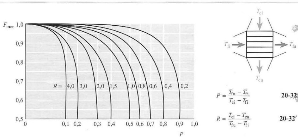
Fig. 20.24 - Fattore di correzione  $F_{incr}$  per lo scambiatore di calore a flusso incrociato di Figura 20.23-c.
