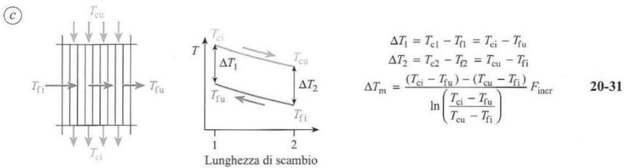
Fig. 20.23 - Differenza di temperatura media logaritmica  $\Delta T_m$  tra fluido più caldo *c* e fluido più freddo *f* per i tipi principali di scambiatori di calore.
